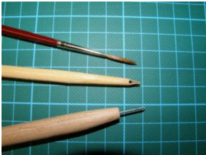
Abb.12 Zeichenwerkzeuge: Oben – Schlepper Mitte - Zeichenfeder aus Holz Unten - Radier- nadel
